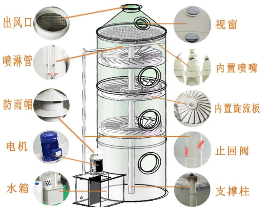
图 6.2-5 湿式除尘工艺原理图
